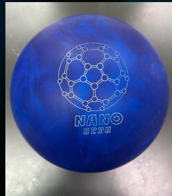
サンディング完了 (表面が白くなりますがクリーナーで拭き取りしてください。)
